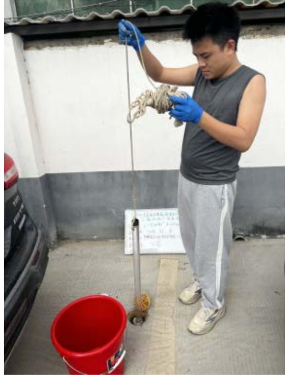
图4.3-2 S2地下水现场采集图
