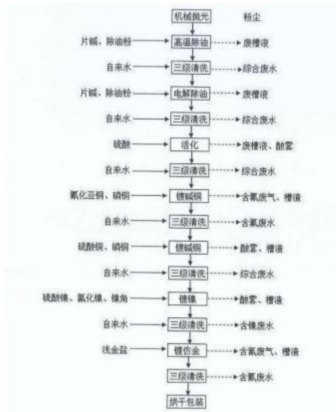
图 3-2 锌合金镀仿金生产工艺流程图
