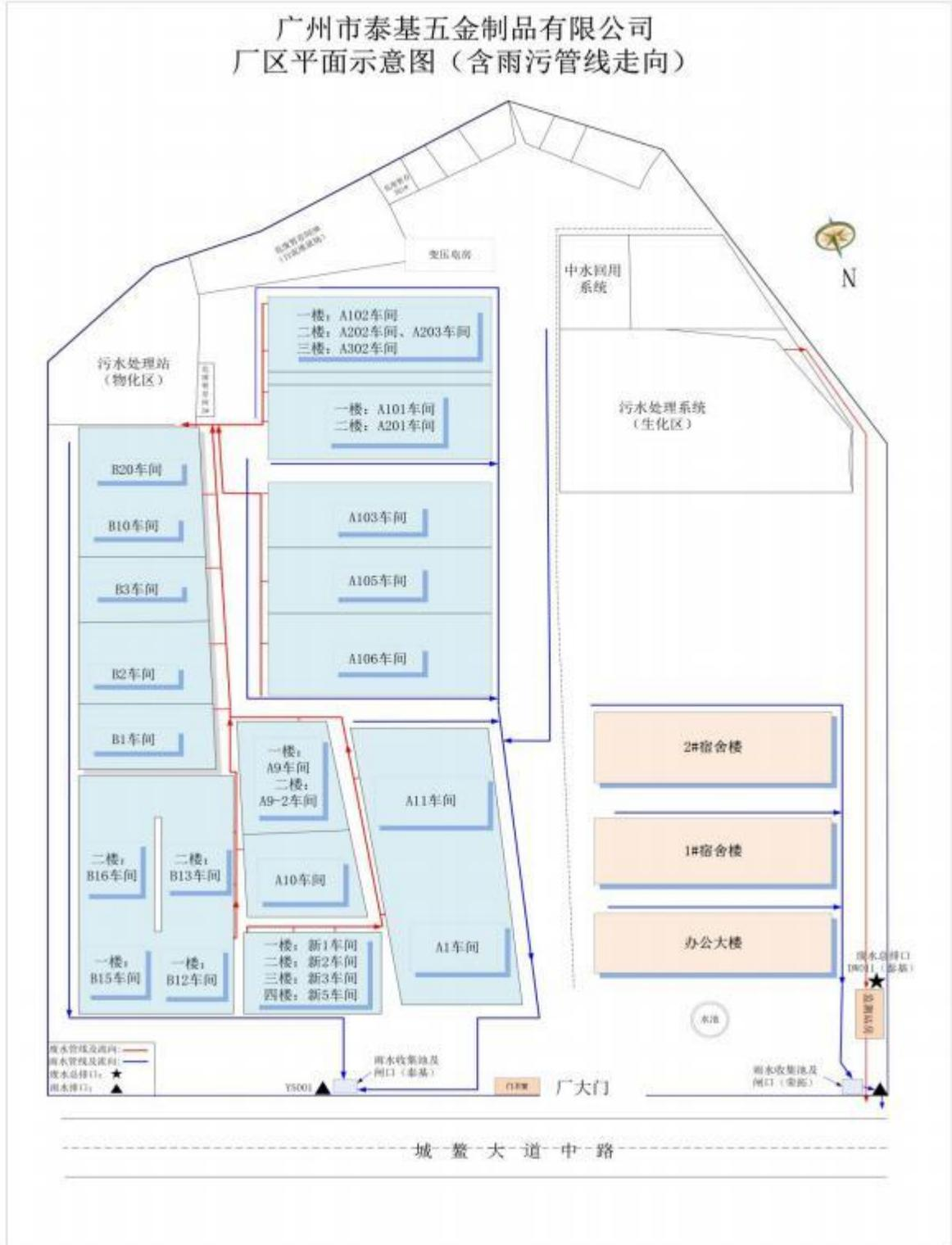
图 2.2-3 厂区废水及雨水管网分布图
