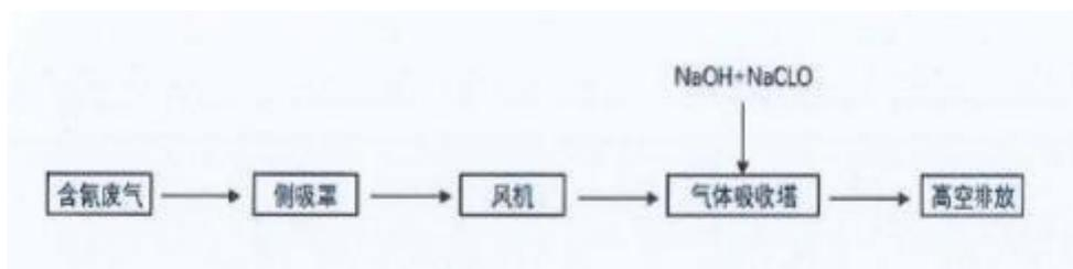
图 3-9 含氰废气净化工艺工艺流程图
