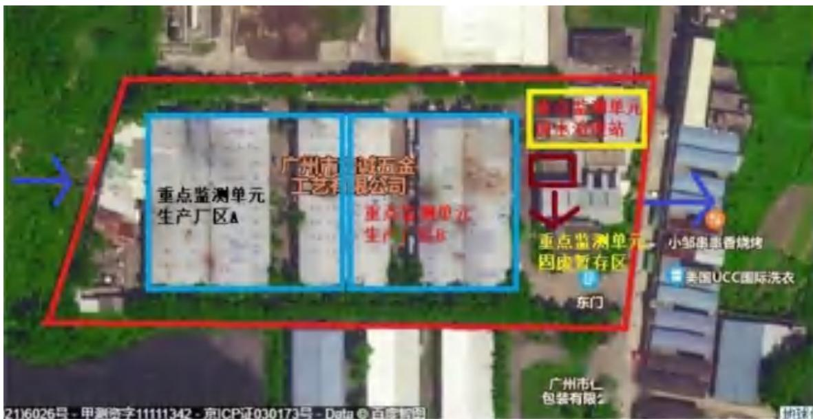
图 4.2-1 有潜在土壤污染隐患的重点场所或者重点设施设备分布图
