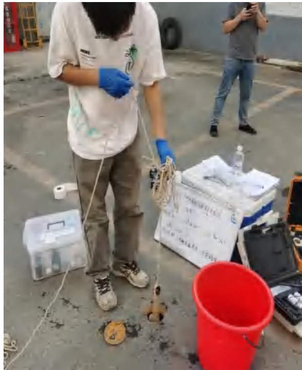
图7.2-7 S3地下水现场采集图（10月12日）
