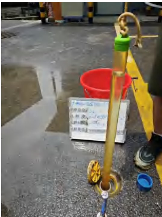
图7.2-6 S3地下水现场采集图（6月28日）
