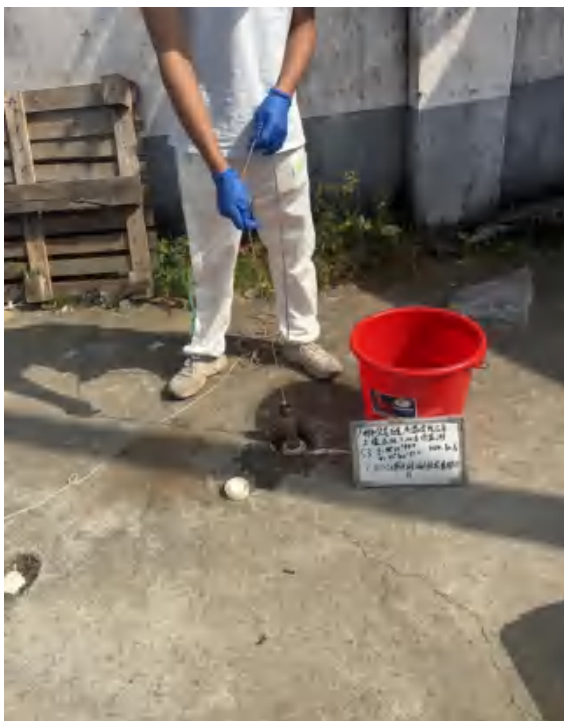
图7.2-7 S3地下水现场采集图（10月12日）
