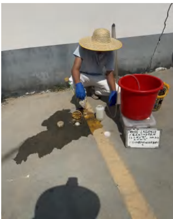
图7.2-5 S2地下水现场采集图（10月12日）
