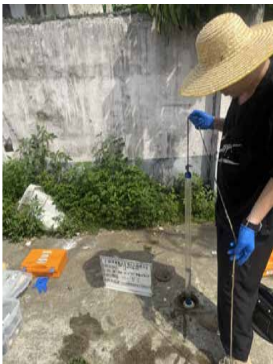
图7.2-8 S3地下水现场采集图（8月7日）
