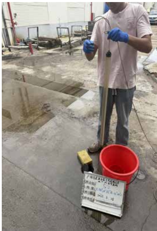
图7.2-4 S2地下水现场采集图（5月28日）
