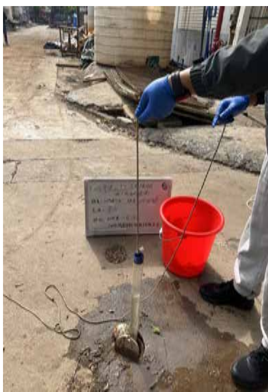
图7.2-6 S2地下水现场采集图（11月19日）
