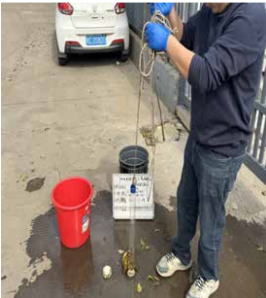
图7.2-11 S4地下水现场采集图（11月19日）
