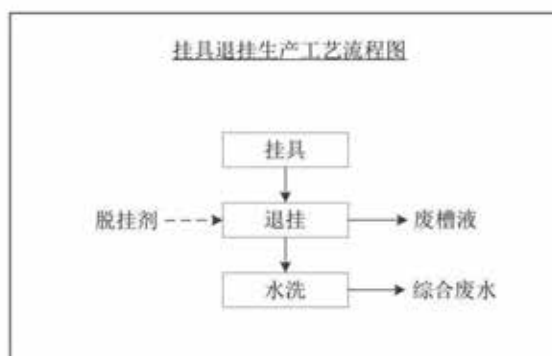
图4.1-3挂具退挂生产工艺流程及产污环节图
